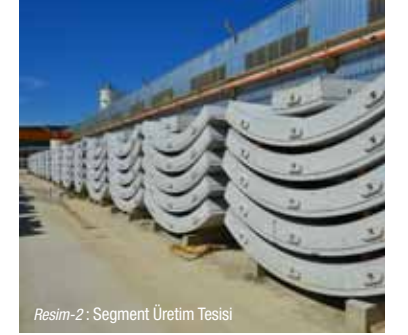
Resim-2 : Segment Üretim Tesisi
